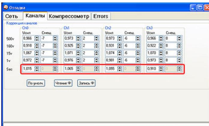
7. Нажмите кнопку **Запись Ф** для того, чтобы сохранить калибровки в приборе.
