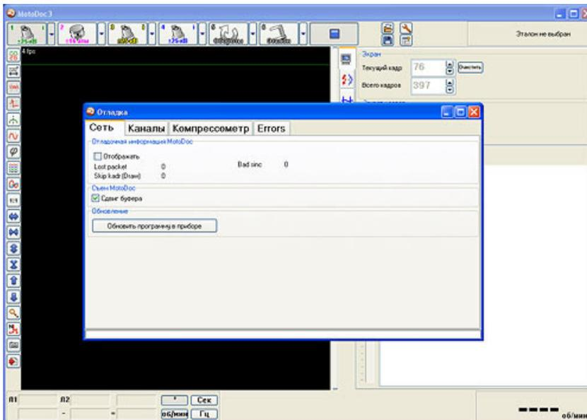
6. Выберите нужный канал в программе и запустите прибор кнопкой **Старт**. В появившейся дополнительной панели выбираем вкладку **Каналы**. На рисунке указаны поля калибровочных коэффициентов для вторичного напряжения. Изменение их в меньшую сторону будет соответствовать уменьшению показаний прибора на осциллограмме, увеличение - соответственно увеличению показаний.
